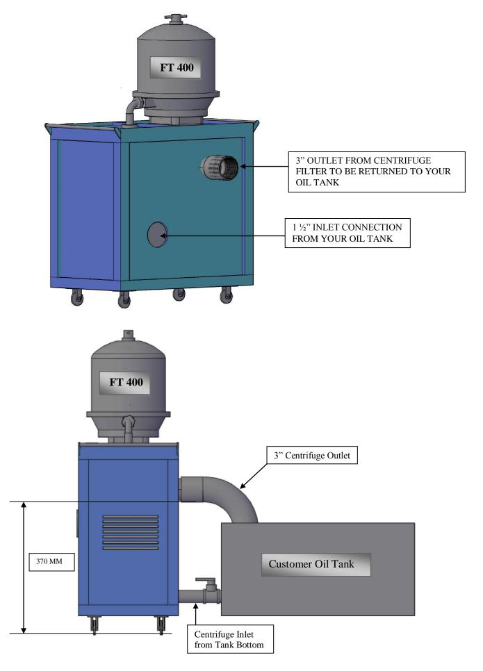
NOTE: HEIGHT OF OUTLET POINT IS 370 MM FROM GROUND LEVEL.
